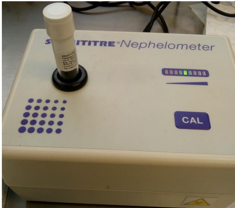
Imagen 2. Nefelómetro. Equipo para calibrar la densidad de sustancias. Fuente propia.
