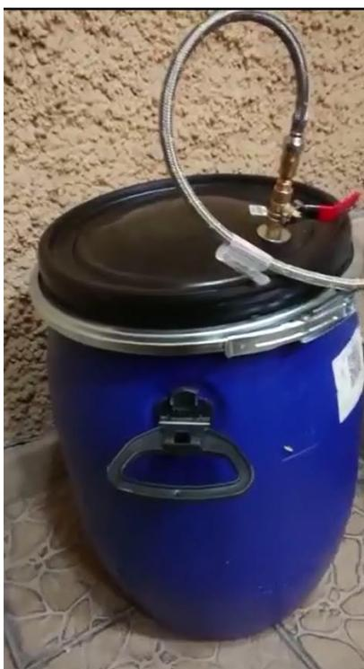
Figura 2. Bidón para uso como biofermentador de elaboración propia con base en el diseño de Reyes-Aguilera (2017).
